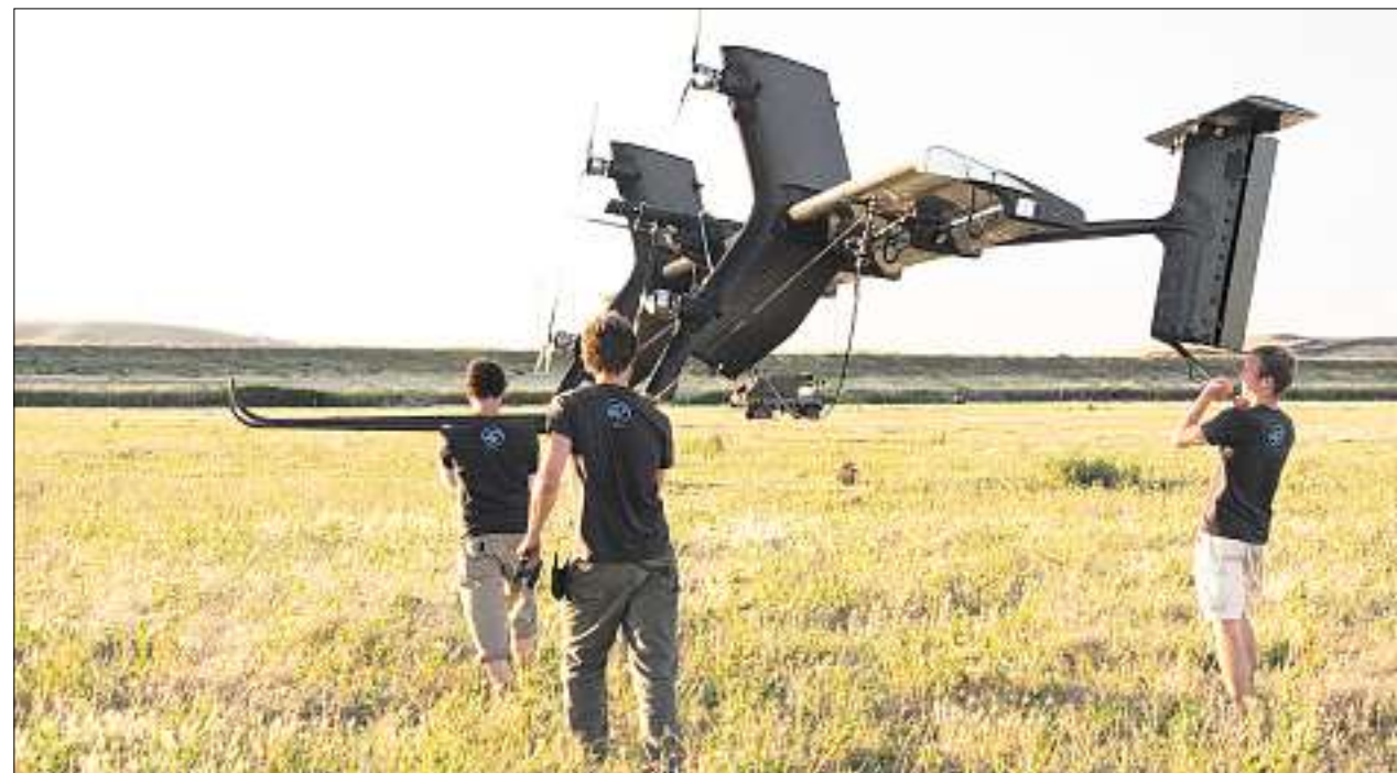
Das Flugzeug vom US-Start-up Makani sammelt mit Propellern die Windenergie ein. Es fliegt wie ein Drache. Als Schnur dienen Strom führende Seile. Gestartet und gelandet wird von einem Tragmast aus. Die Generatoren fungieren dann als Motoren. Foto: Makani
